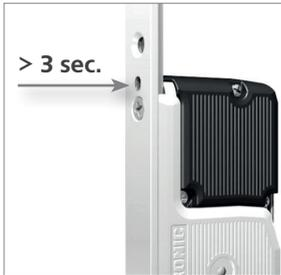
1. Appuyez avec précaution sur le bouton de programmation du module Smart radio pendant au moins 3 secondes.
