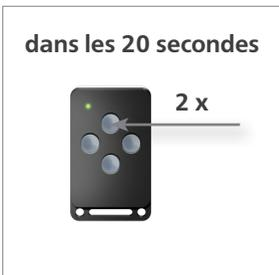
3. Appuyez deux fois dans les 20 secondes sur le bouton de transmission de la SmartKey pour être syntonisé.
